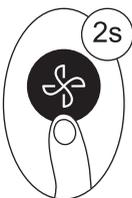
Mantenga pulsado el botón Fan (Ventilador) durante más de 2 segundos para activar / desactivar la función Silencio (algunos modelos). Puede resultar en una capacidad de enfriamiento y calefacción insuficiente debido a la operación de baja frecuencia del compresor. Pulse el botón ON/OFF (ENCENDIDO/APAGADO), Mode (Modo), Sleep (Dormir), Turbo o Clean (Limpiar) durante el funcionamiento cancelará la función Silence (Silencio).
