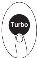
Cuando selecciona la función Turbo en el modo de REFRIGERACIÓN, la unidad soplará aire frío con la configuración del viento más fuerte para iniciar el proceso de refrigeración.
